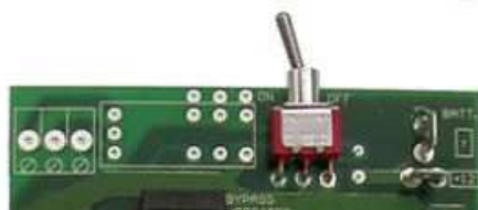
Av/På bryter i standplass- og gravskap
