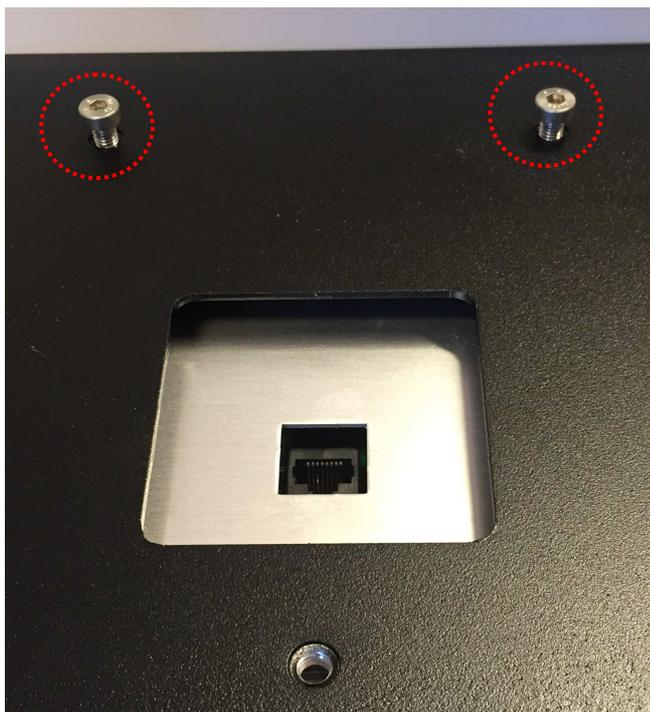
Koble RJ45 kontakten fra stativet inn i kontakten på undersiden av skiva. Dytt så skiva med umbracoskruene inn i festet på skiva.
