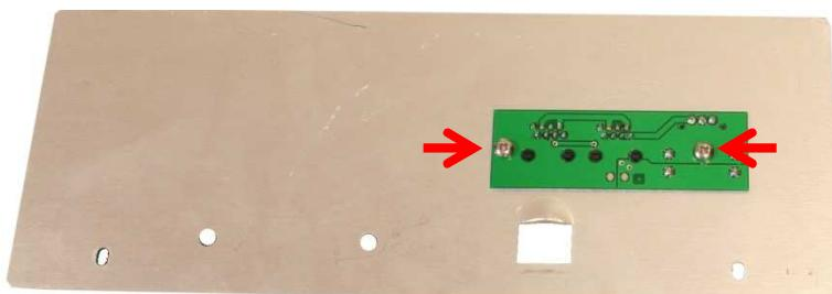
Den nye bakplaten monteres på baksiden av 4K187 skiva. Pass på at hullet over kontakten passer slik at kabelen greit går inn.
