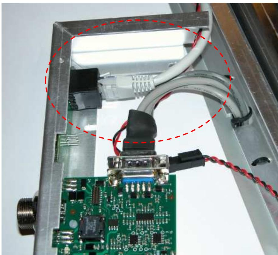
Koble til kabelen fra lampene inn i lyskontrolleren.
