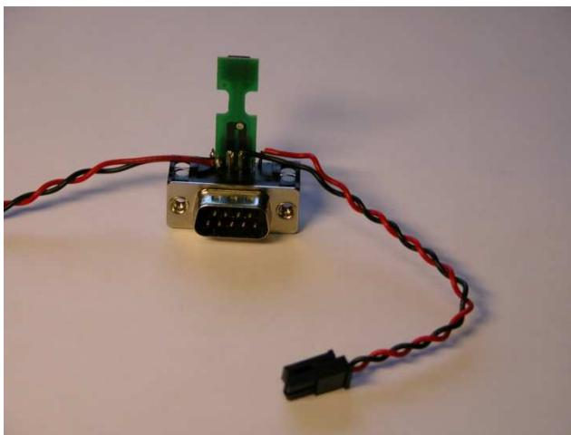
Bytt ut den gamle temperatursensoren. Den nye temperatursensoren har ledning som skal kobles til rammesensoren.
