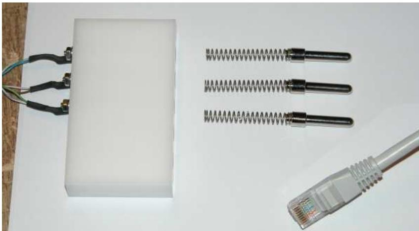
Monter rammekontakten på høyre side. Passende hull finnes allerede. Kun de tre øverste kontaktene er i bruk.
