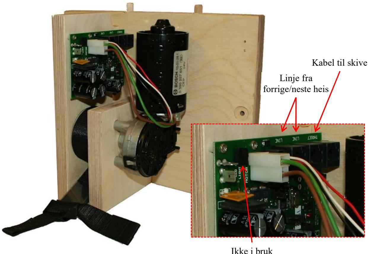
Dersom skiveheisen er av en tidligere type må elektronikken i denne skiftes ut. Pass på at enkelte av skruenhullene har byttes posisjon.
