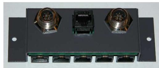
Hver skive kobles til et av de fem skiveuttakene (RJ45 kontakter). Det benyttes en rett RJ45 kabel (for eksempel en nettverkskabel).
