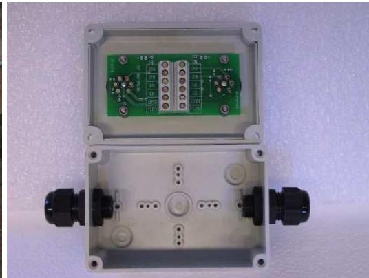
Dersom man velger løsningen på bildet over til venstre anbefales det at niplene monteres inne i bunnen av kontaktboksen. Dersom boksen monteres på andre måter vil man normalt montere niplene i endene av boksene. Niplene monteres ved å borre hull i boksen på ønsket sted. Mål niplen først for å finne riktig bor (normalt 19mm).
