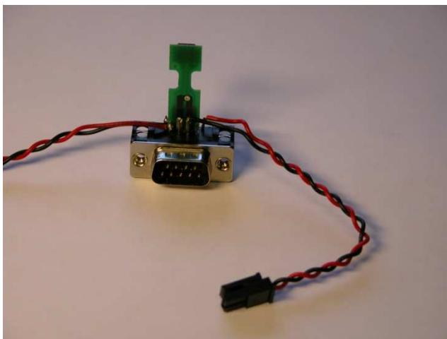
Bytt ut den gamle temperatursensoren. Den nye temperatursensoren har ledning som skal kobles til rammesensoren.
